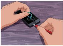
02 Befestigen Sie den mitgelieferten Saugnapf an der Vorderseite des Telefons. Drücken Sie den Saugnapf auf den Bildschirm, etwas über der Home Taste. Tragen Sie genügend Druck auf, um eine dichte Verbindung herzustellen. Dies ist notwendig, um die vordere Hälfte des Telefons zu halten, während Sie versuchen, diese vom unteren Teil zu trennen.
