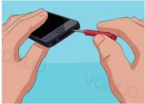
O1 Entfernen Sie die beiden Pentalobe-Schrauben neben dem Lightning-Anschluss. Dies ist der Ladeanschluss an der Unterseite des Telefons. Sie benötigen einen Pentalobe-Schraubendreher, um diese Schrauben zu entfernen.
