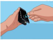
05 Öffmen Sie das iPhone so, dass das Display im 90 °-Winkel zur Basis steht. Verwenden Sie die Oberseite als Scharmier und legen Sie den Bildschirm gegen ein Buch oder eine Box in einem Winkel von 90 °, damit Sie die Innenseite bearbeiten können, ohne sie halten zu müssen. Achtung! Nicht weiter öffnen, sonst kann es zu Beschädigungen der innenliegenden Kabel kommen.
