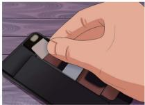
O6 Entfernen Sie die zwei Schrauben mit denen die Akkuanschlusshalterung befestigt ist. Diese Halterung befindet sich ungefähr Z5mm von der Unterseite des Telefons entfernt, direkt rechts von der Batterie. Benutzen Sie den Schraubendreher, um die Schrauben, die die Kabelhalterung umgeben, zu lösen. Benutzen Sie nun Ihre Finger, um die Frontblende der Kabelhalterung vorsichtig ab zu ziehen.
